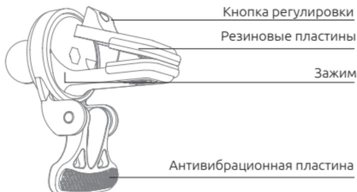
Вставьте держатель до упора в подходящую для этого лопасть дефлектора. С помощью кнопки регулировки зафиксируйте зажим крепления держателя в решетке воздуховода. Устройство совместимо с большинством видов дефлекторов, включая горизонтальные, вертикальные и круглые.
